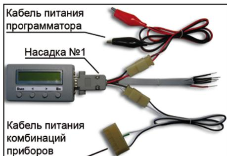
Рисунок 8. Подключение насадок и кабелей питания для программирования одометров
