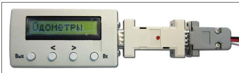
Рисунок 12. Подключение к программатору адаптера с насадкой
