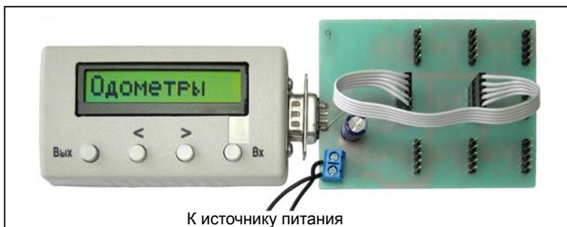
Рисунок 15. Подключение адаптера ПО5-EEPROM к программатору
